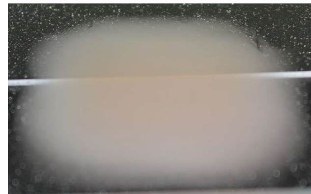
ガラス上にレジスト膜 (段差のあるワークに対する塗布)
